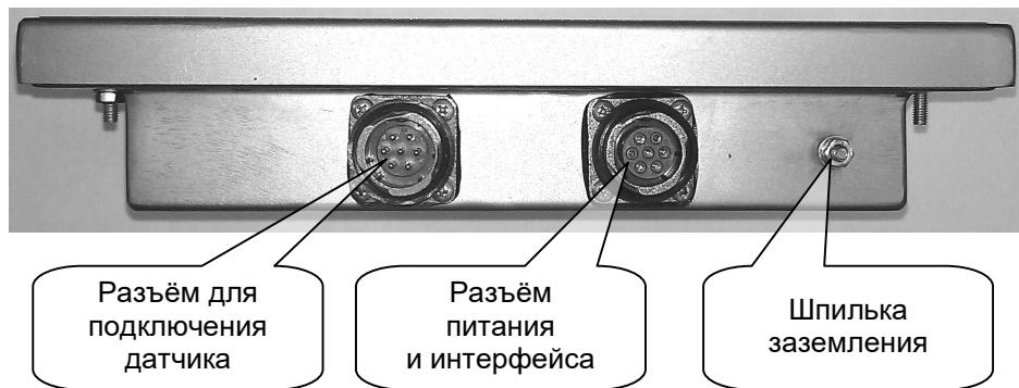
Рис. 7.2. Внешний вид ВТ Преобразователя со стороны панели разъёмов.
