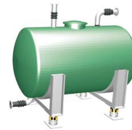
Рис. 4. Пример снижения жесткости «паразитных» связей путем вставки гофров для повышения точности ТВЭУ
