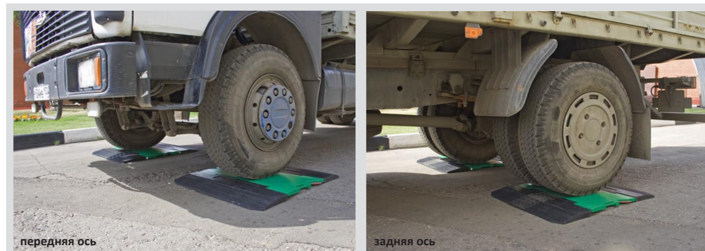
Рис. 4. Поосное взвешивание автомобиля на весах ВА-П
