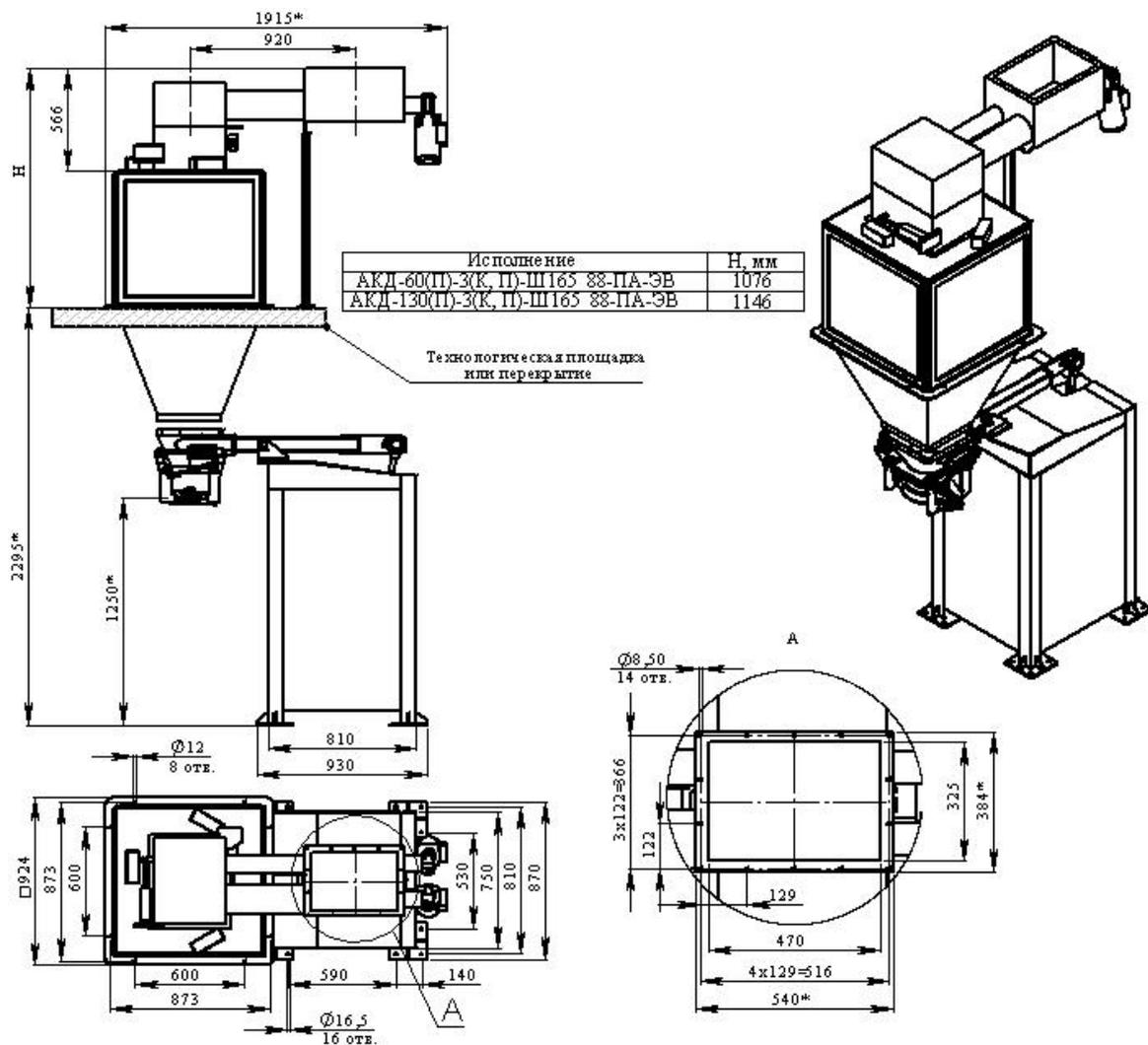
Рис. 1. Габаритно-установочные размеры.
