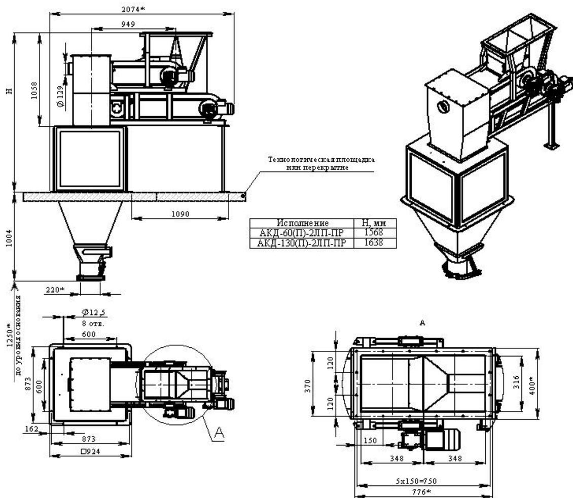
**Рис. 1. Габаритно-установочные размеры.**
