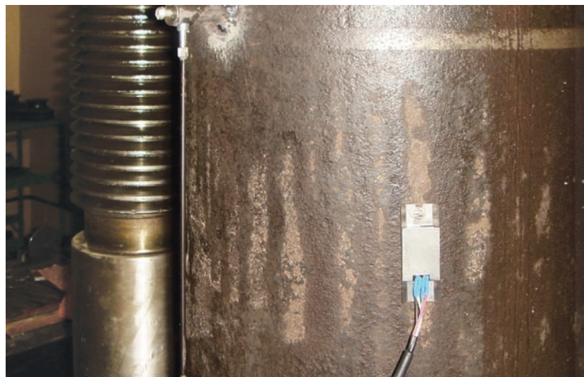
Нагружение на гидравлическом прессе трубы со съемным тензометром. Проверка измерительного канала на реальной строительной конструкции
