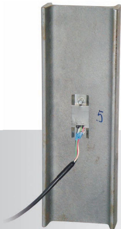
Пример установки съемного тензометра на двутавр №10
