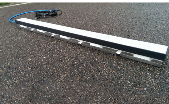
Рис. 4. Силоприемный модуль системы «СВК»
