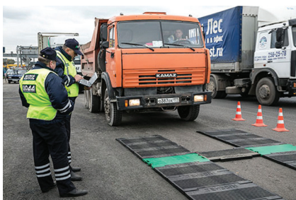
Рис. 2. Портативные автомобильные весы «ВА-П»
